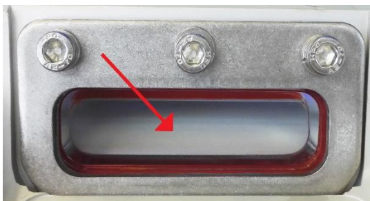
Figura 19 – Pulizia del prisma
