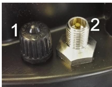
Figura 17 – Coperchio inferiore con valvola di pressione
