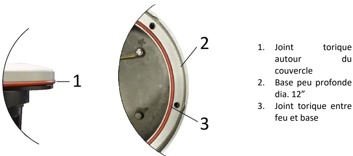
Figure 11 – Joint pour base peu profonde standard 12"
