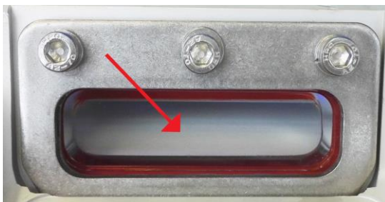
Figura 19 – Pulizia del prisma
