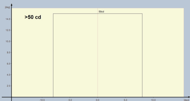
Fig. 1: FAP-170 6.1.5 Indicatore di Zona di Toccata a bassa intensità
